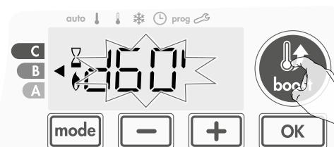
Durant la première minute, vous pouvez augmenter la durée du Boost de 0 à la durée maximale autorisée définie dans les paramètres avancés (voir la page 12 pour plus de détails) par intervalles de 5 minutes (ou plus rapidement par pressions de plus de 2 secondes) en appuyant sur **-** et **+**.
