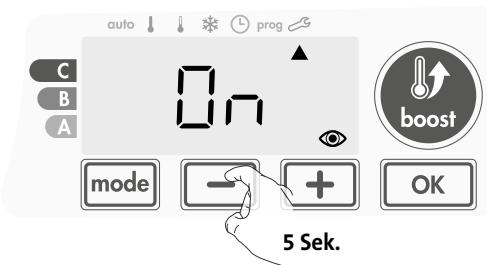
3- Zum Speichern der Einstellung und automatischen Fortfahren mit der nächsten Einstellung drücken Sie **OK**. Zum Verlassen der Installationseinstellungen drücken Sie 3 Mal auf **mode**.
