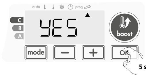
Le symbole Boost et l'indicateur de chauffage apparaissent sur l'afficheur et la température maximale clignote.
