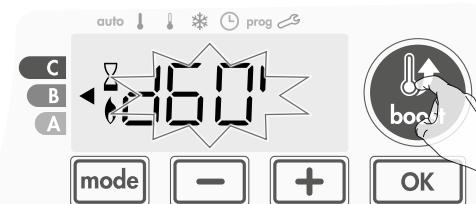
In der ersten Minute können Sie, wie in den erweiterten Einstellungen definiert (weitere Details siehe Seite 69) die Boost-Dauer von 0 auf die maximal genehmigte Dauer in Intervallen von 5 Minuten (oder noch schneller durch mehr als 2 Sekunden langes Drücken) mit der Taste und ändern.
