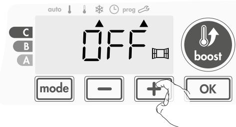
2- Um die Einstellung zu speichern und mit der nächsten Einstellung fortzufahren, drücken Sie **OK**. Um die Installationseinstellungen zu verlassen, drücken Sie **mode** 3 Mal.
