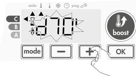
3- Deze wijziging wordt automatisch geannuleerd aan het eind van de boostcyclus.
