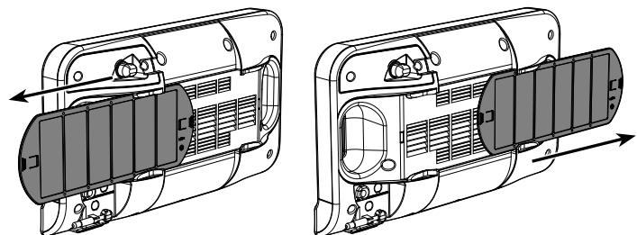
2 - Gebruik een stofzuiger om het stof op de filter weg te halen. Was de filter onder een waterkraan met een vochtige spons, als hij erg vuil is. Laat de filter na het wassen drogen.
