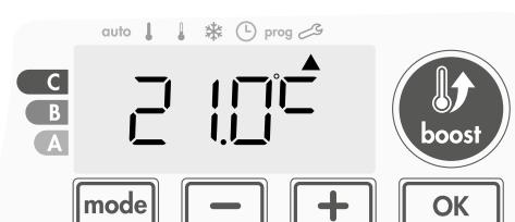
Erhöhen Sie die vom Umgebungstemperatursensor gemessene Temperatur um 2 °C, indem Sie drücken.
