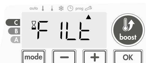
De blazer blijft werken maar verwarmt niet. Controleer of er niets voor de ventilatierooster is geplaatst om de luchtstroom niet te blokkeren. De filter is mogelijk verstopt met stof. Hij moet worden gereinigd (zie pagina 19).
