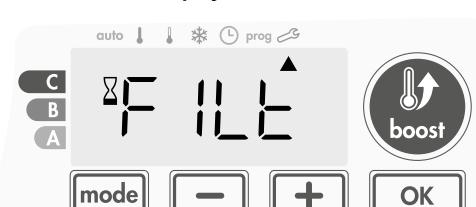
Das Gebläse arbeitet weiterhin, heizt aber nicht. Überprüfen Sie, ob sich etwas vor dem Lüftungsgitter befindet, das den Luftdurchfluss blockiert. Möglicherweise ist der Filter durch Staub verstopft und muss gereinigt werden (siehe Seite 76).
